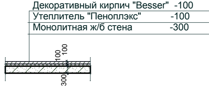
Сечение стен автостоянки ниже 0,000 выше уровня земли
