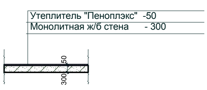
Сечение стен автостоянки ниже 0,000 ниже уровня земли
